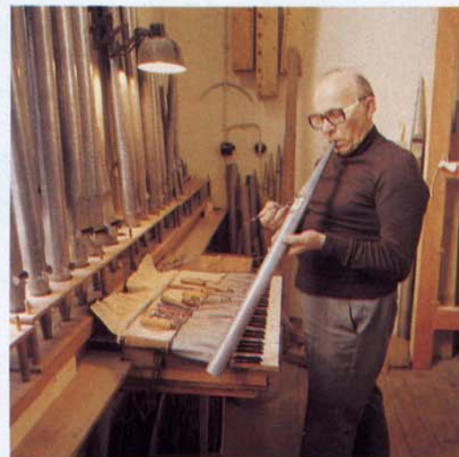
Mit der Intonierlanze und anderen Stimmbestecken bringt Josef Weimbs Orgelpfeifen wohlklingende Flütentöne bei. Sie werden heute genau wie im Mittelalter gegossen; die kleinsten sind 4 mm (!), die größten 12 m lang.
