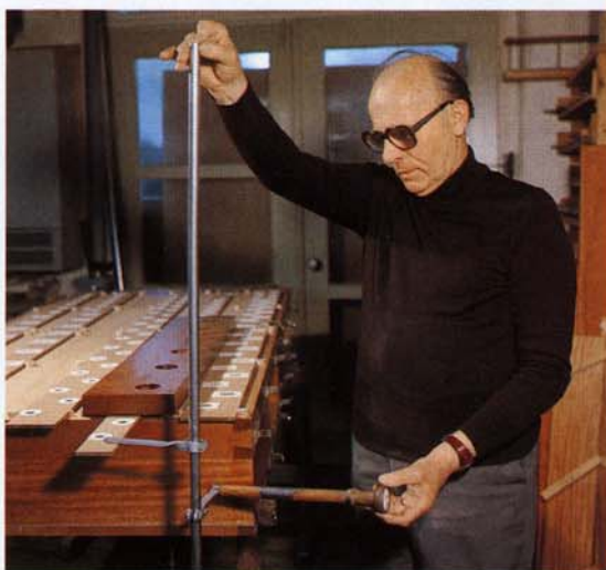
„Je härter und fester das Rohmaterial, um so besser. MRW-Reaktorrohre aus Hellenenthal sind für mich darum gerade richtig!“ Das Zirkaloyrohr dient, drehbar gelagert, dem Orgelbauer als Verbindungs- bzw. Übersetzungsstück eines Registerzuges.
