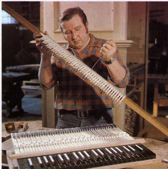
Winkelbalken und Ebenholztastatur müssen miteinander harmonisieren. Ehe er beide Tonübertragungsgeräte abstimmt, zieht Hans-W. Eiserfey eine Schraubenreihe an.
