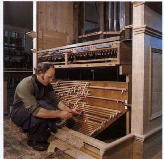
Das „Innenleben“ einer historischen Orgel (Baujahr 1580). Zu sehen sind Schleifenwindlade (oben) und Wellenbrett, beide originalgetreu restauriert. Josef Müsch baut noch eine Spieltraktur ein.
