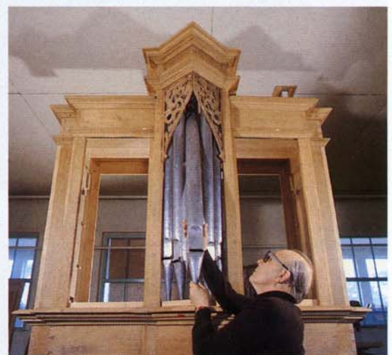
Die Hilberather können sich freuen: Pfingsten werden sie ihr kostbares Instrument wieder spielen hören. Josef Weimbs hat nicht nur die alten Pfeifen (70% Blei, 30% Zinn) repariert – er befestigt gerade die letzte an ihrem Platz –, sondern auch das massive Eichengehäuse „aufgemöbelt“.
