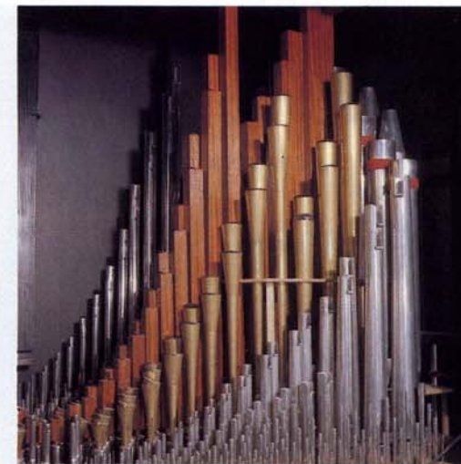
Ein Blick ins Schwellwerk zeigt das Materialspektrum der Pfeifen. Ihr Gros besteht aus einer Blei-Zinn-Legierung. Seltener, dafür aber – wie im Falle der Gemünder Kirche – im Obertonbereich unentbehrlich: Mahagoni-Dulziane, Messingschalmern und Kupferklangkörper.
