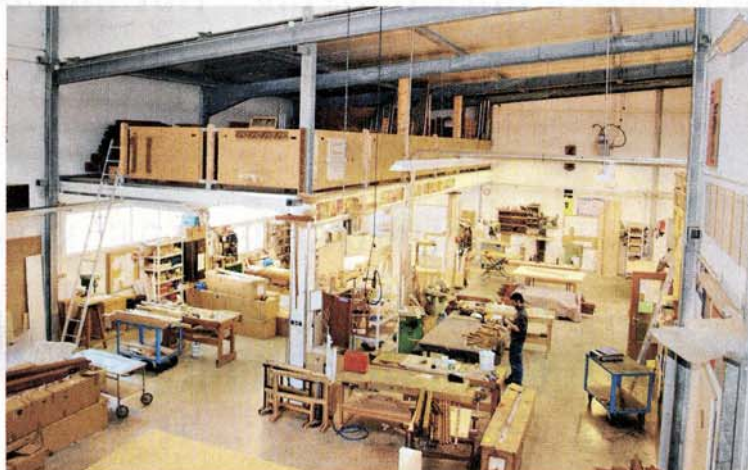
In der großen Fertigungshalle im Hellenthaler Industriegebiet werden alle klingenden Meisterstücke hergestellt, probeweise aufgebaut, wieder abgebaut und an ihren endgültigen Standort transportiert. BILDER: GKL
